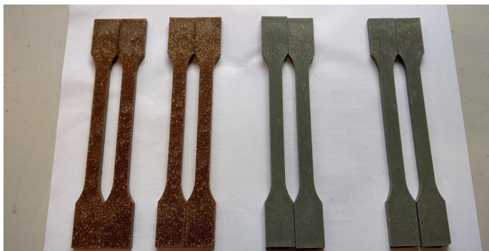
Figuur 11: Spuitgiet trekstaven van respectievelijk hennephout en referentvezel in virgin (links) en recycled HDPE (rechts)
