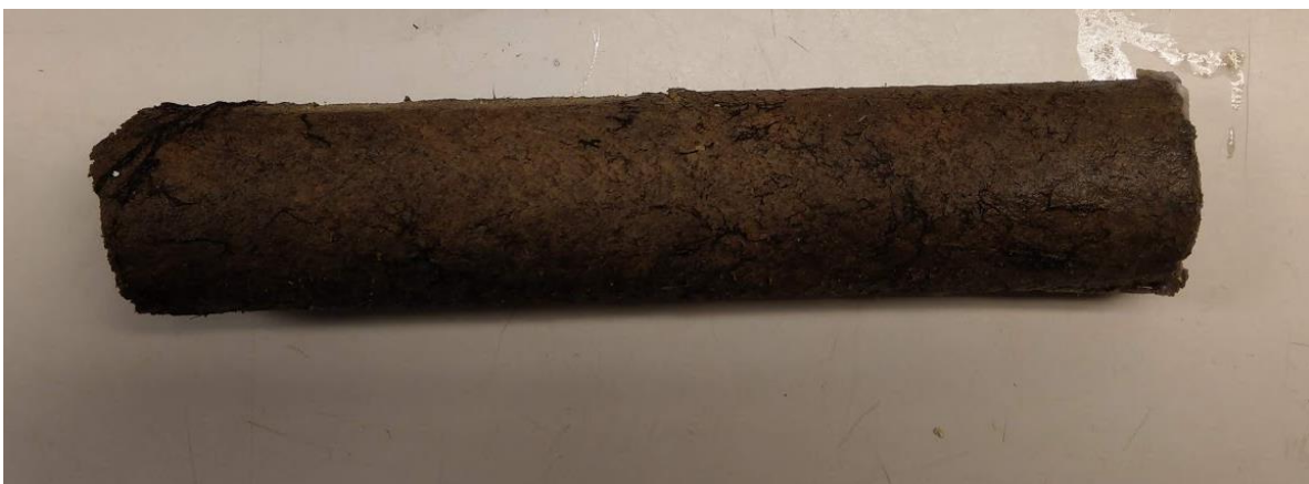
Figuur 10: Profiel welke onder de grond heeft gezeten met plantwortels aan de buis gehecht
