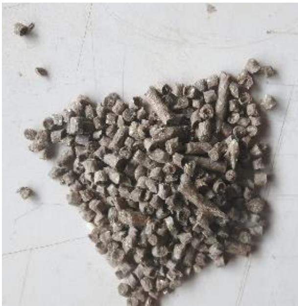
Figuur 6 : Compound pellets met 30% hennephout in biopolymeren
