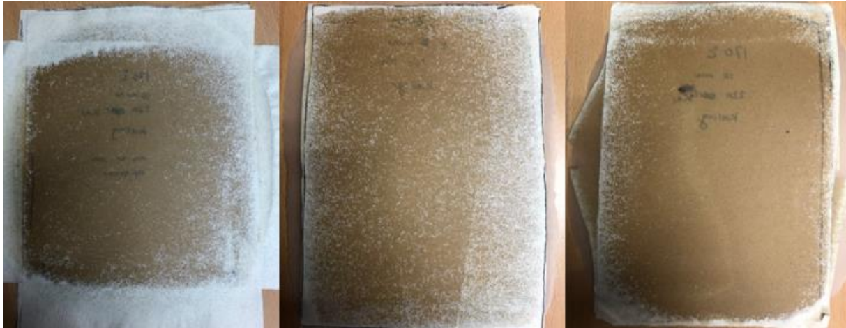
Figuur 12 Testen huidplaten van 25% spruitkoolpapier met PLA
